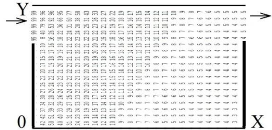
Рис. 1. Концентрация субстрата в биореакторе (нет пластин, сценарий № 1)
